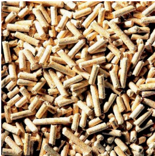
Fig. 7 Das Lignin ist verantwortlich für den Zusammenhalt der Pellets
