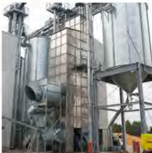
Deutschland/Germany MDB-XN 1/10-SU Kapazität / capacity: 38,5 t/h 19% -> 15% (Weizen/Wheat) 11 t/h 35% -> 15% (Mais/Maize)
