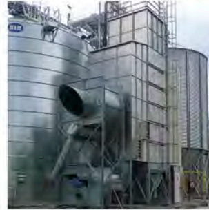
Tschechische Republik / Czech Republic MDB-XN 1/6 Kapazität / capacity: 32 t/h 19% -> 15% (Getreide/wheat) 8 t/h 35% -> 15% (Mais/maize)
