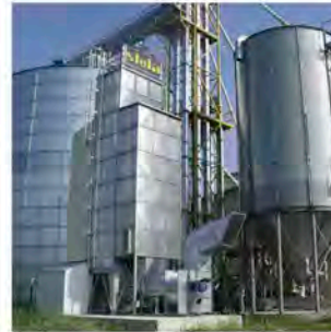
Tschechische Republik / Czech Republic MDB-TN 1/6-S Kapazität / capacity: 16,5 t/h 19% -> 15% (Weizen/Wheat) 5,1 t/h 35% -> 15% (Mais/Maize)
