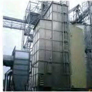
Kroatien / Croatia MDB-XN 1/6 Kapazität / capacity: 27,5 t/h 19% -> 15% (Getreide/wheat) 11 t/h 25% -> 15% (Mais/maize)
