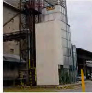
Rumänien / Romania MDB-TN 1/5 Kapazität / capacity: 17,5 t/h 19% -> 15% (Getreide/wheat) 7 t/h 25% -> 15% (Mais/maize)
