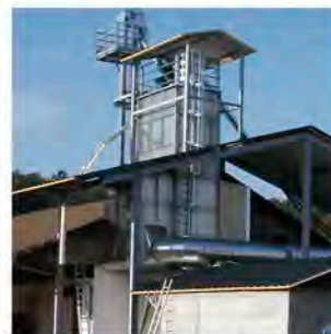
Österreich / Austria MDB-TN 1/3 Kapazität / capacity: 10 t/h 19% -> 15% (Getreide/wheat) 4 t/h 25% -> 15% (Mais/maize)
