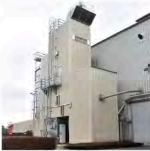
Deutschland/Germany MDB-TN 1/7-S Kapazität / capacity: 5,7 t/h 35% -> 15% (Mais/maize)
