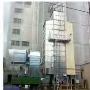
Tschechische Republik / Czech Republic GDB-XN 1/10-S Kapazität / capacity: 27,5 t/h 12% -> 8% (Raps/Rape)
