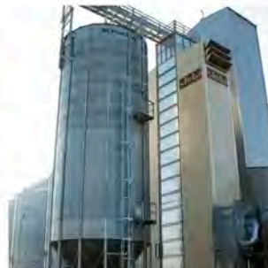
Serbien / Serbia MDB-XN 1/15 Kapazität / capacity: 75 t/h 19% -> 15% (Getreide/wheat) 30 t/h 25% -> 15% (Mais/maize)
